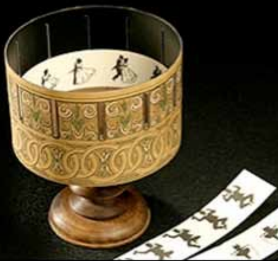
Zoótrope, de los étimos griegos ζωός (zoós), adjetivo que significa “vivo” y τροπή (tropé), máquina creada en 1834 por William George Horner; los dibujos dispuestos en tiras sobre el tambor, al girar, den la ilusión de animación.
