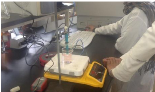
▼ Figura 2. Calibración del potenciómetro (pH system). Fuente propia.
