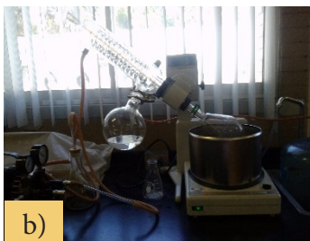
Figura 3. Maceración de la planta (a), concentración del extracto en rotavapor (b) y obtención de extractos (c).
