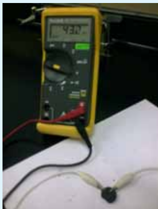
Figura 5. Mediciones de resistencia de la pastilla a 20°C
