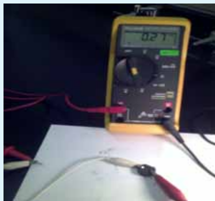
Figura 4. a) Circuito eléctrico en serie con la pastilla, b) medición de la corriente eléctrica a través de la pastilla.
