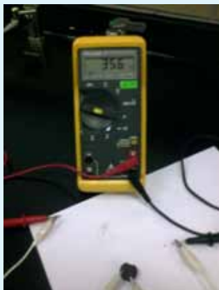
Figura 5. Mediciones de resistencia de la pastilla a 20°C
