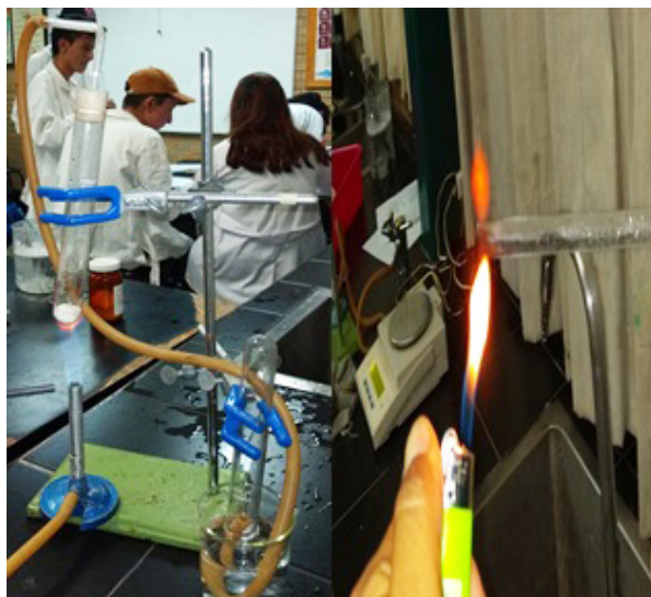
Imagen 34. Izquierda. Dispositivo para recuperar el metano al calentar la mezcla de reacción. Derecha, prueba con un encendedor doméstico para corroborar su alta flammabilidad.
