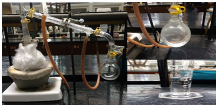
Imagen 45. Proceso de destilación y aspecto del bioetanol obtenido en el laboratorio.
